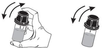
Để tránh rơi rớt hóa chất và giúp kết quả đo chính xác hơn, đóng nắp cuvette bằng nắp nhựa HDPE trước khi đóng bằng nắp đen.
