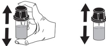
Để tránh rơi rớt hóa chất và giúp kết quả đo chính xác hơn, đóng nắp cuvette bằng nắp nhựa HDPE
