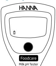
Khi pin yếu, màn hình sẽ nhấp nháy ký hiệu này. Khi hết pin, màn hình sẽ hiển thị "Erb" rồi tắt máy.
