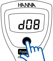
Từ màn hình đo, nhấn giữ phím ON/OFF đến khi màn hình hiển thị "d08" (giá trị mặc định, 8 phút) thì tắt ra. Nhấn lần nữa để thay đổi thời gian tự động tắt khi không sử dụng sang "d60" (60 phút). Để vô hiệu hóa tính năng này, nhấn phím ON/OFF lần nữa, LCD sẽ hiển thị "d--". Nhấn giữ để thoát ra ngoài.
